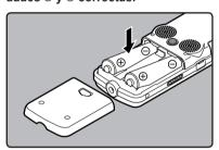
Cierre completamente la cubierta de las pilas presionando en la dirección (A) y, a continuación, deslizándola en la dirección (B).
