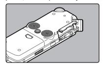
2 Coloque la tapa en la posición correcta e insértela en la ranura de la tarjeta como se muestra en el diagrama.
