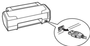
Puede utilizar [IMPR.SIMPLE] incluso con la cámara apagada o en modo de fotografía. Con la cámara apagada o en modo de fotografía, conecte el cable USB. Aparece la pantalla de selección para la conexión USB. Seleccione [IMPR. SIMPLE].
