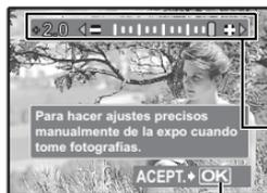
Presione △/☒/☐ en modo de fotografía, ajuste con ◀▶, y presione (OK).
