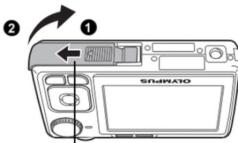
Tapa del compartimento de la batería/tarjeta
