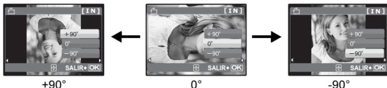
Seleccione una fotografía con  $\triangleleft$  $\triangleright$ , y seleccione [90°] / [0°] / [-90°] con  $\triangle$  $\nabla$  para rotar las imágenes. Puede rotar varias imágenes uno después de otro.
