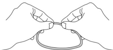
使用不容易脱落纤维丝的清洁布、绵棒等清除O-环槽中的异物，并以同样的方法清除防水机壳前盖、后盖的O-环接触面上的沙粒和灰尘。
