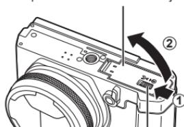
Bloqueo del compartimento de la batería/tarjeta
