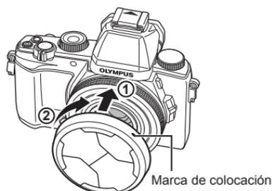
Coloque la tapa del objetivo de forma que la marca de colocación • gire hasta arriba.
