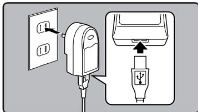
**3** Com o gravador desligado, ligue o cabo USB ao terminal de ligação na parte inferior do gravador, premindo o botão STOP ■.
