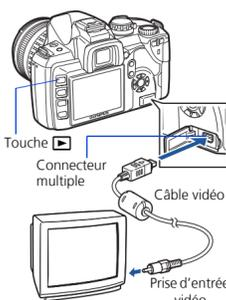
b. Mettez le téléviseur en marche et commutetez-le sur le mode d'entrée vidéo. Pour le détail sur la sélection du mode d'entrée vidéo, consultez le mode d'emploi du téléviseur.
