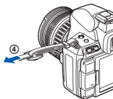
Passez le couvercle de l'objectif dans une extrémité de la courroie. Passez la courroie tel qu'indiqué par les flèches.
