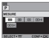
Appuyez sur la touche **OK** pour afficher le menu direct indiqué à l'emplacement du curseur. Vous pouvez également utiliser le menu direct pour modifier le réglage. Une fois le réglage modifié, appuyez sur la touche **OK** pour confirmer le réglage. Si aucune opération n'est effectuée pendant quelques secondes, votre réglage est confirmé et le grand écran de contrôle s'affiche.
