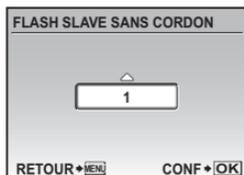
Appuyez sur  $\triangle$ / $\nabla$  pour sélectionner un niveau d'émission entre [1] à [10], et appuyez sur  $\text{OK}$ . Le plus grand nombre indique la plus grande quantité de lumière émise par le flash.
