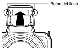
! La configuración del flash no puede realizarse con el flash cerrado.
