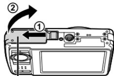
Tapa del compartimento de la batería/tarjeta
