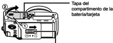
Bloqueo del compartimento de la tarjeta/batería
