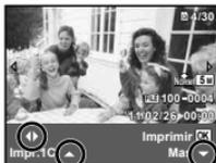
Las guías de funcionamiento mostradas al pie de la pantalla indican que se pueden usar el botón MENU, el botón  $\odot$  o la palanca del zoom.
