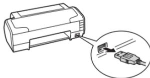
Vous pouvez utiliser [IMPRESSION FACILE] même lorsque l'appareil photo est éteint ou que le mode prise de vue est activé. Lorsque l'appareil photo est éteint ou que le mode prise de vue est activé, connectez le câble USB. L'écran de sélection de la connexion USB s'affiche. Sélectionnez [IMPRESSION FACILE].
