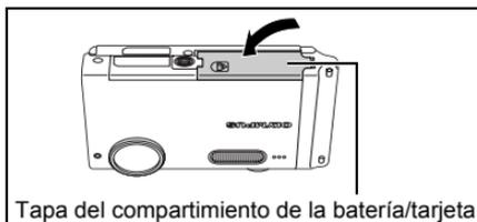
Tapa del compartimento de la batería/tarjeta
