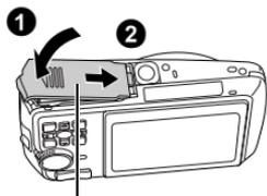
Tapa del compartimiento de la batería/tarjeta
