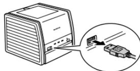
Puede utilizar [IMPR. SIMPLE] incluso con la cámara apagada o en modo de fotografía. Con la cámara apagada o en modo de fotografía, conecte el cable USB. Aparece la pantalla de selección para la conexión USB. Seleccione [IMPR. SIMPLE].
