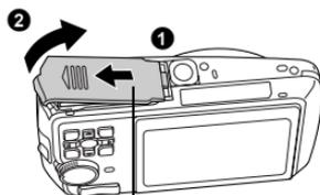
Tapa del compartimento de la batería/tarjeta
