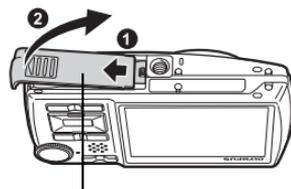
Tapa del compartimiento de la batería/tarjeta
