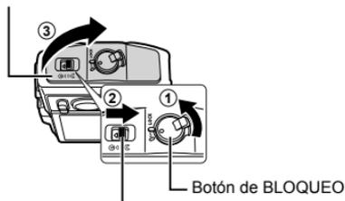
Bloqueo de la tapa de la batería/tarjeta
