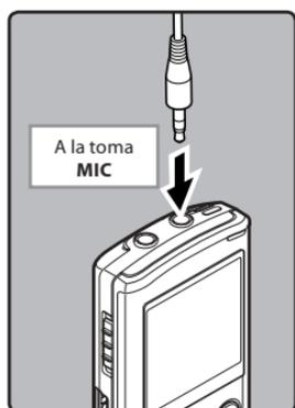
Se puede conectar un micrófono externo u otros dispositivos y grabar sonido. Realice las conexiones de la siguiente manera según el dispositivo a ser utilizado.
