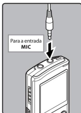
Pode ser conectado um microfone externo ou outros dispositivos, e o som pode ser gravado. Efetue as seguintes conexões, conforme o dispositivo utilizado.
