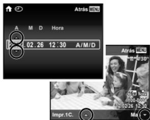
Las guías de funcionamiento que se muestran en la pantalla indican que se pueden utilizar el botón **MENU**, el botón  $\odot$  o la palanca del zoom.
