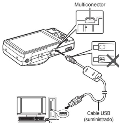
Si [Conexión USB] está ajustado en [Auto], conecte la cámara y el ordenador, seleccione [Guardado] o [MTP] en la pantalla para seleccionar el método de conexión y luego presione el botón
