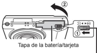
Bloqueo del compartimento de la tarjeta/batería
