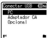
**[PC]:** Ajuste para cuando la grabadora se conecta al ordenador y se utiliza como dispositivo de almacenamiento o dispositivo compuesto. Conectado como almacenamiento o compuesto.
